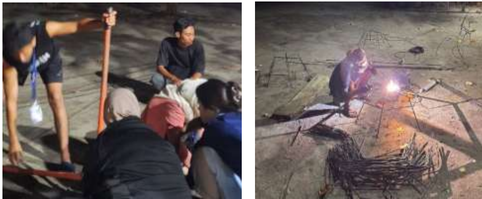
Gambar 4. Proses pembuatan rangka media terumbu karang
