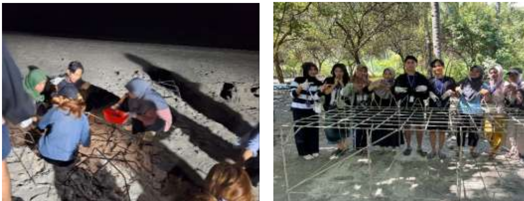
Gambar 5. Pelapisan resin pada media terumbu karang
