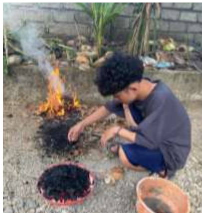
Gambar 1. Proses Pembakaran Batok Kelapa untuk menghasilkan arang
