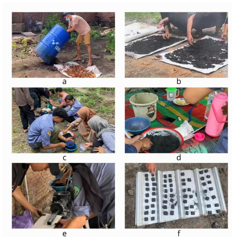
Gambar 1. Proses Pembuatan Briket; a) Pembakaran Tempurung Kelapa, b) Pengeringan Arang, c) Penggilingan dan Pengayakan Arang Halus, d) Pengadonan, e) Pencetakan, f) Pengeringan Briket
