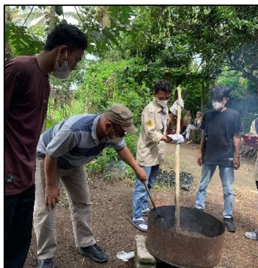
Gambar 11. Proses penambahan fly ash pada adonan pembakaran plastik.
