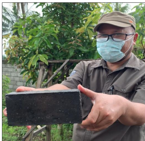
Gambar 13. Bata ringan setelah dikeluarkan dari cetakan
