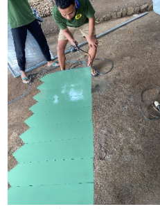
Gambar 7. Pemberian Warna Hijau Dasar Cat Pada Plat Petunjuk Arah
