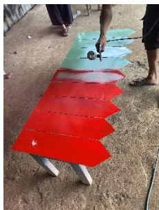
Gambar 7. Pemberian Warna Hijau Dasar Cat Pada Plat Petunjuk Arah
