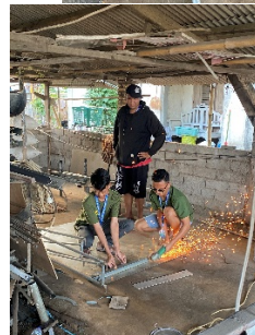
Gambar 4. Pemotongan Tiang dan Plat Petunjuk Arah
