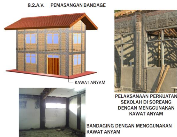
Gambar 11. Perbaikan Dinding Retak Akibat Guncangan Gempa Dengan Bandage Kawat Anyam (Sumber: Boen (2020))
