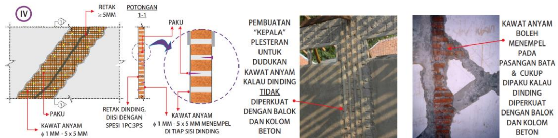
Gambar 10. Perbaikan Dinding Retak Akibat Guncangan Gempa Dengan Menggunakan Kawat Anyam (Sumber: Boen (2020))
