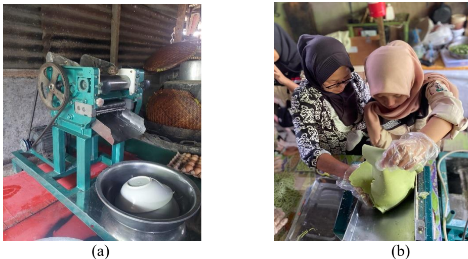
Gambar 4. (a) Mesin roll press (b) Proses pembuatan lembaran mie dengan alat roll press
