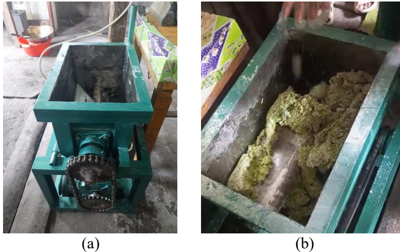
Gambar 3. (a) Mesin pengaduk, (b) Proses pengadukan bahan menjadi adonan mie
