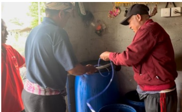
Gambar 3. Proses penyimpanan bahan fermentasi dalam drum plastik food-grade dengan pelepasan gas terkontrol (Dokumentasi pribadi, Juni 2025).
