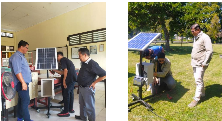
Gambar 4 Perakitan dan pengujian modul PLTS 50 Wp
