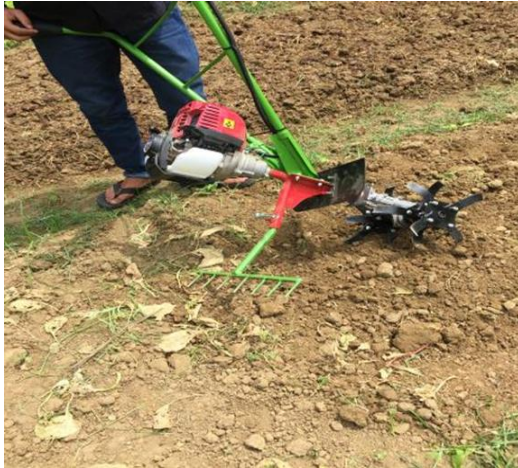
Gambar 12. Alat pengendali gulma yang ditambah garu pada bagian belakang
