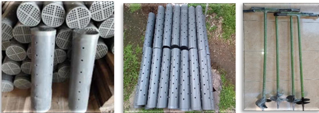
Gambar 3. Pipa paralon yang telah dilubangi dan Bor tangan (Kanan)
