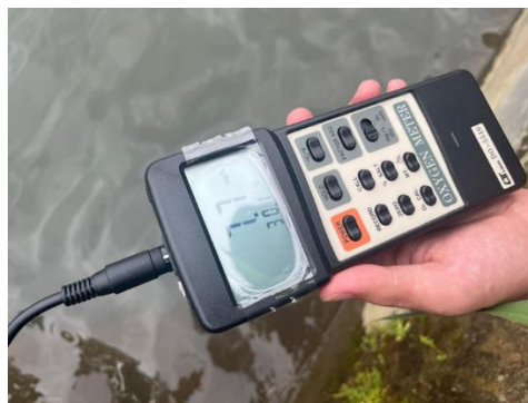
Gambar 3. Pengecekan kadar dissolved oxygen (DO) atau oksigen terlarut pada kolam budidaya nila.
