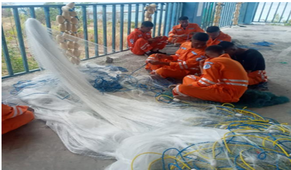
Gambar. Perakitan Alat tangkap Gill Net Dasar Monofilament
