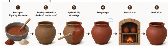
Gambar 1. Skema proses pewarnaan dengan tehnik slip clay coating hematite
