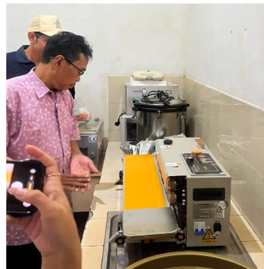
Gambar 1. Teknologi Sterilisasi yaitu autoclave dan sealer
