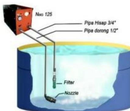
Gambar 4. Penerapan Teknologi Nano Bubble dalam Kolam Terpal (Puspitasari *et al.*, 2022)
