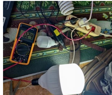
Gambar 12. Pengukuran arus lampu menggunakan Multimeter Digital DT9205A.
