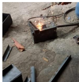
(a) Pembuatan kotak pack nitriding (b) Pemotongan specimen
