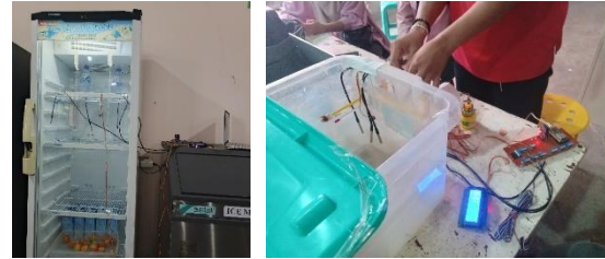
Gambar 3. Proses Kalibrasi Sensor DS18B20 dan Sensor SHT31
